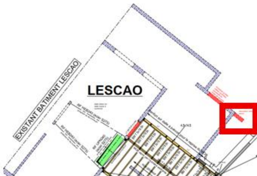
Extrait plan STRUCTURE phase DCE indiquant le retour béton à démolir
